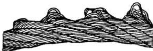
Рисунок 11 Выдавливание проволок прядей: а – в одной пряди; б – в нескольких прядях
